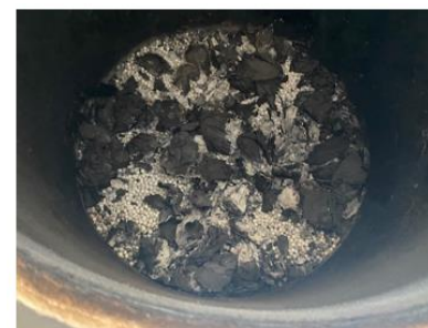
実証実験写真 下段左より 熱分解後の炉内 残渣・セラミック灰除去状況 同減容後のセラミック灰
